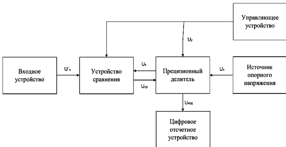
Рис. 2. Структурная схема кодоимпульсного вольтметра
