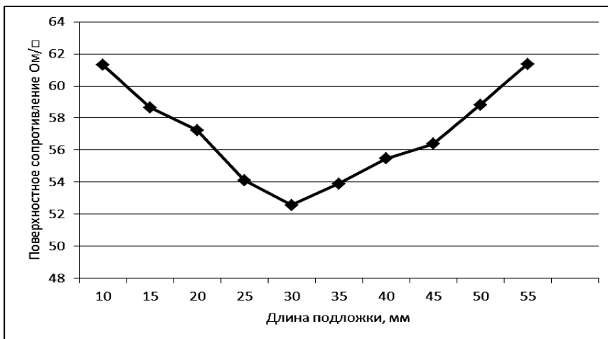
Рис. 2. Неравномерность распределения сопротивления по поверхности подложки
