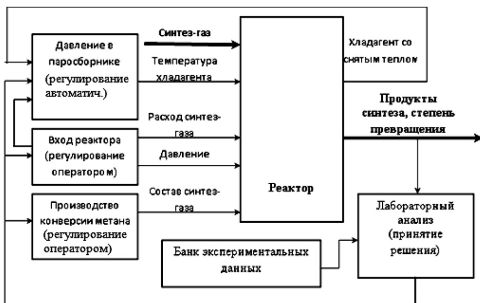
Рис. 1. Структурная схема системы управления процессом синтеза углеводородов
