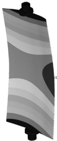
Рис. 2. Нагрузки на поворотную направляющую лопатку компрессора ГТД
