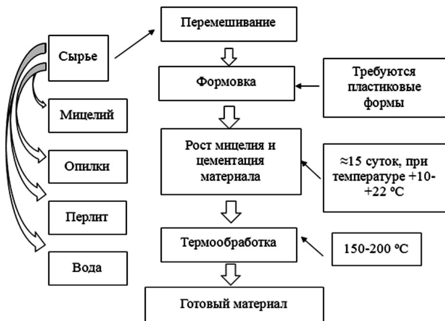
Рис. 1. Принципиальная технология получения утеплителя на основе грибного мицелия
