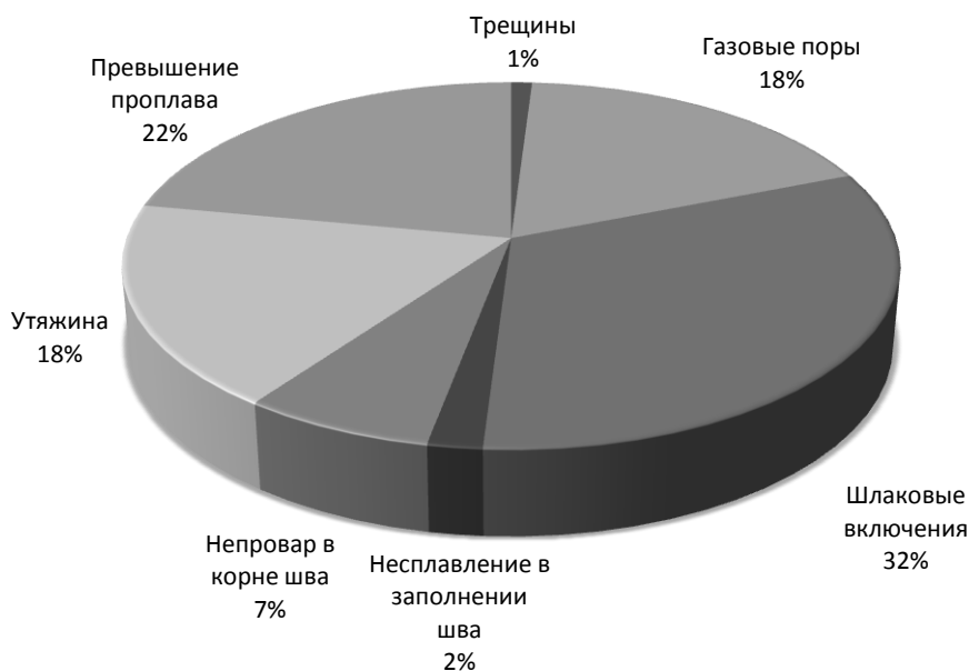
Рис. 2. Диаграмма распределения дефектов сварных соединений МГ «Пунга-Ухта-Грязовец»
