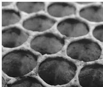
Рис. 2. Сотовый композиционный каркас из расплава АК12
