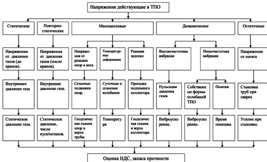
Рис. 1. Типы, виды и причины возникновения напряжений в ТПО под действием различных факторов
