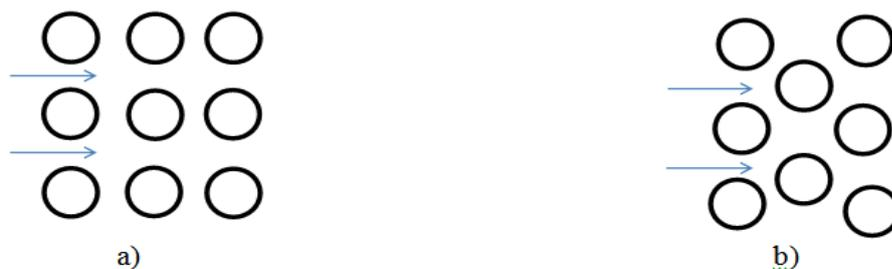
Рис. 2. Размещение труб в обогревателе а) коридор, б) шахматы
