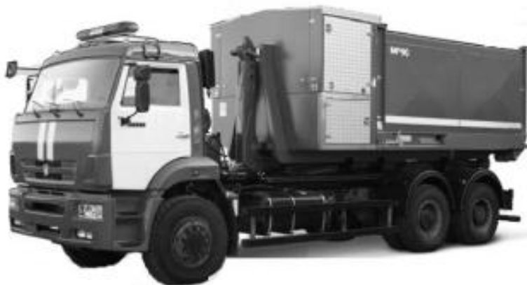
Рис. 2. Насосно-рукавный комплекс НРК «Поток» на шасси КамАЗа 6520
