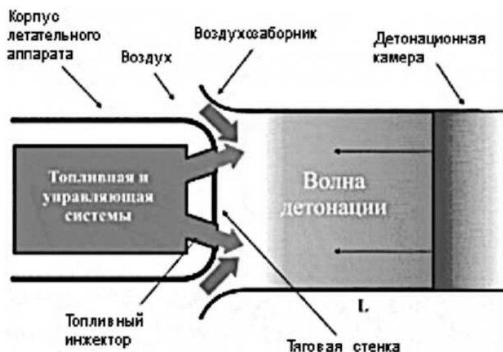
Рис. 1. Конструкция ИДД
