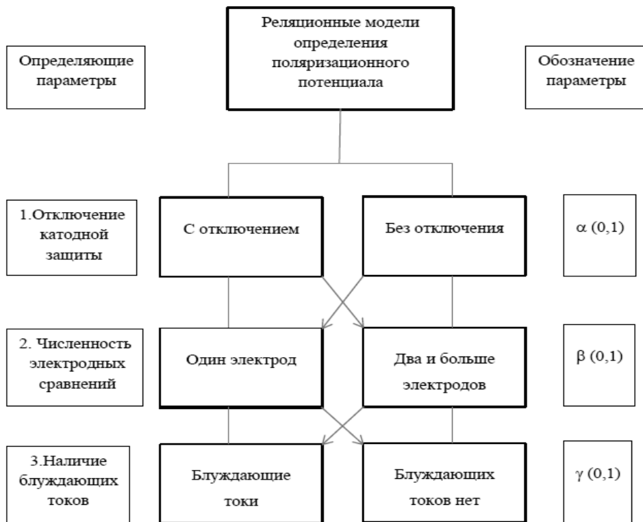
Рис. 1. Модель определения поляризационного потенциала: \alpha = 0 , станция катодной защиты отключена; \beta = 1 , имеем два или более электродов сравнения; \gamma = 0 , токи, блуждают, присутствуют
